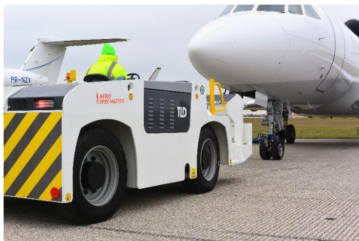
Taxibot : véhicule commandé par un pilote pour faire rouler l'avion avec les moteurs principaux éteints
